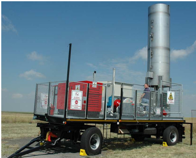
Entgasungs- und Verbrennungsanlage IPL1c 500 auf Anhänger montiert
